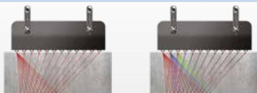
В приборе используется метод синтезированной фокусируемой апертуры с комбинационным зондированием (САФТ-К), при котором происходит фокусировка ультразвука в каждую точку полупространства.
