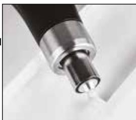
R (МПа), используя встроенные в прибор универсальные градиуровочные зависимости в диапазоне классов бетона B7,5-B35 и B35-B60 (ГОСТ 17264-2012 Бетоны. Ультразвуковой метод определения прочности).
